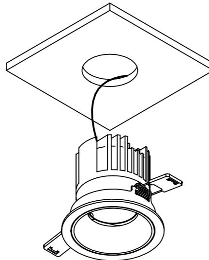
3. Posicione o driver sobre o forro e encaixe a luminária.
