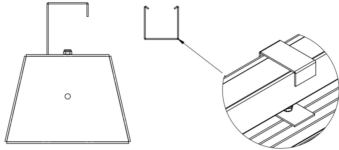
(2) Instale a luminária encaixando o suporte no perfilado.
