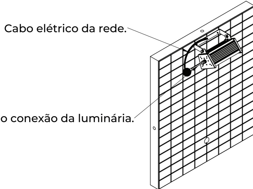
3. Conecte os cabos da rede elétrica ao Cabo de conexão da luminária.
