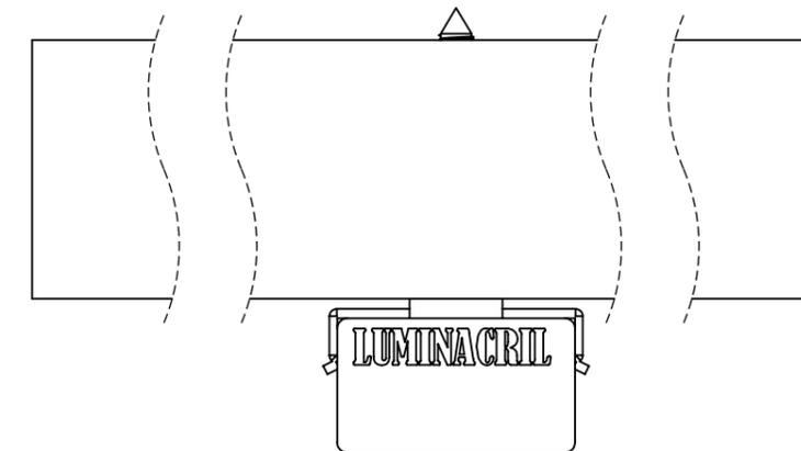
(4) encaixe a luminária na mola já fixada na superfície.
