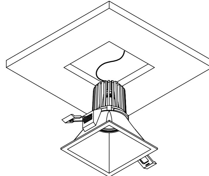
3. Posicione o driver sobre o forro e encaixe a luminária no forro.
