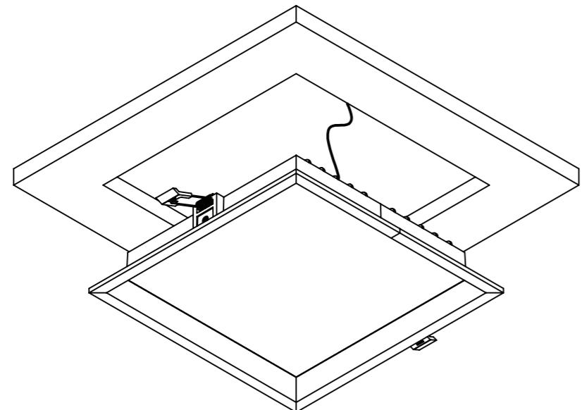
3.Posicionar driver sobre o forro e encaixar luminária no forro.
