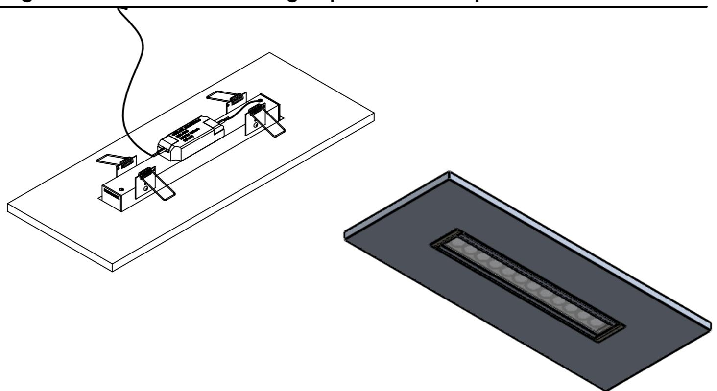
**3. Suspenda a Luminaria ajustando as molas de fixação para encaixe no nicho.**
