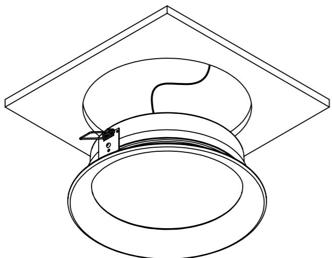
3. Posicionar driver sobre o forro e encaixar luminária no forro.
