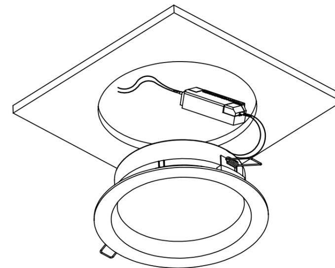
2. Com a Rede elétrica desligada conectar a Rede ao driver Ligando e Isolando os Fios.
