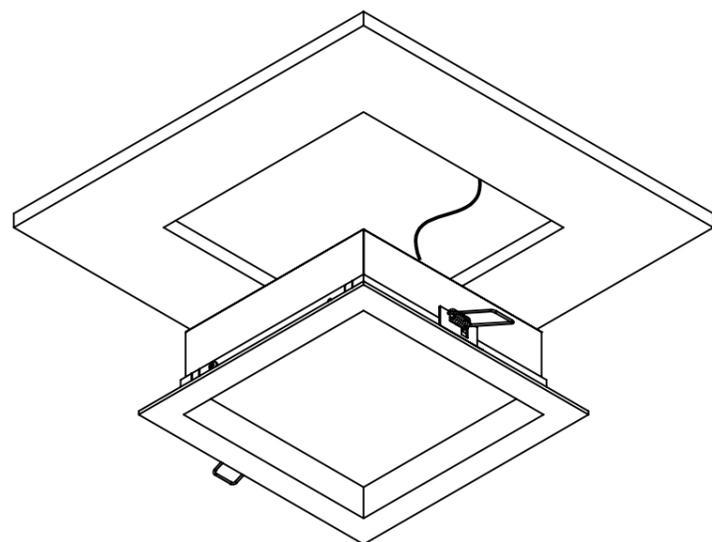
**3. Posicionar driver sobre o forro e encaixar luminaria no forro.**
