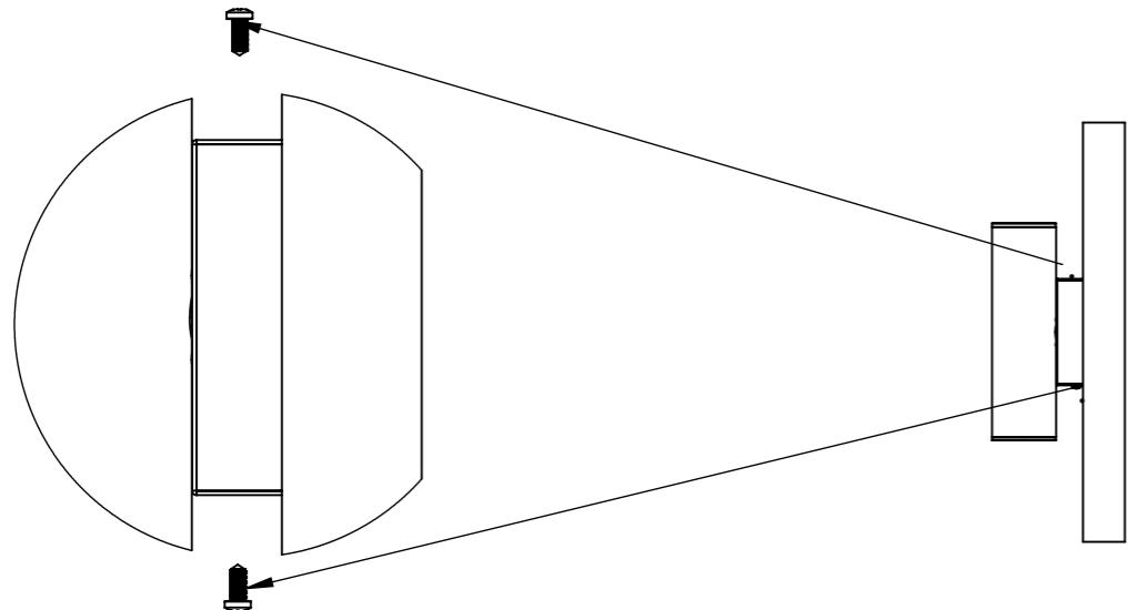
3. Posicionar a luminária e fixar com parafuso.
