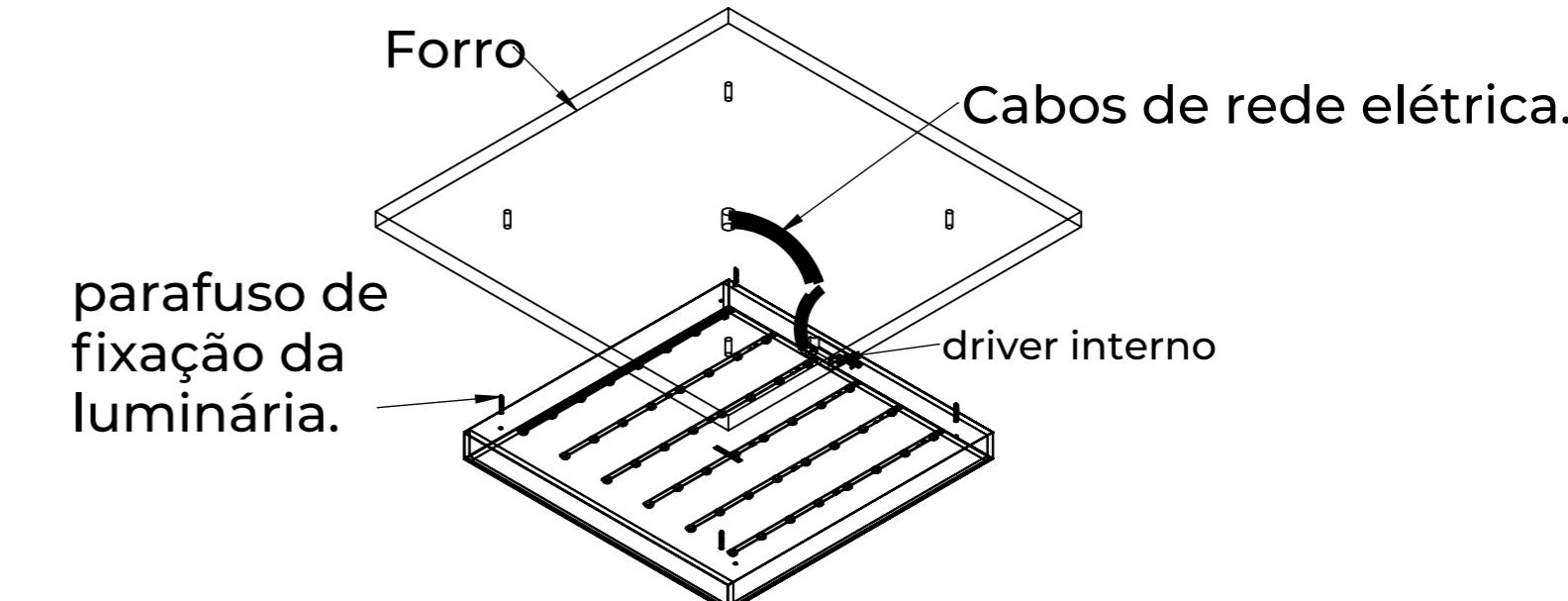
2. Conecte os fios do driver na rede e fixe a luminária com parafusos.
