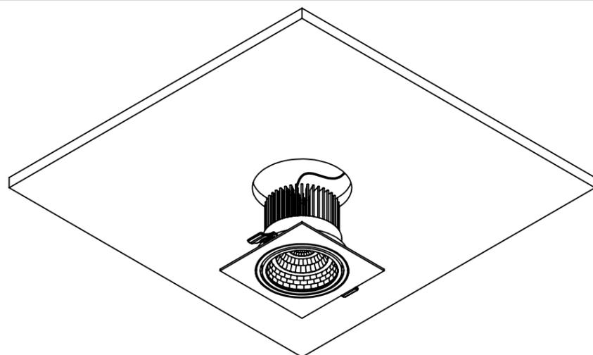
**3. Posicionar driver sobre o forro e encaixar luminaria no forro.**
