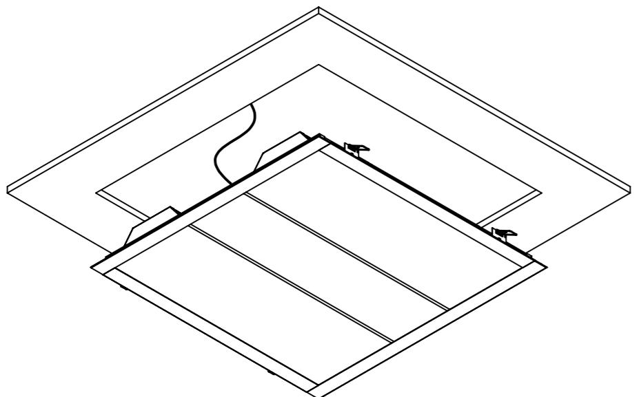
3. Posicionar driver sobre o forro e encaixar luminária no forro.
