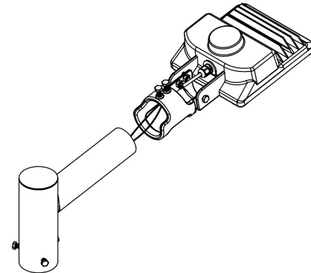
2. Conecte os cabos de energia da rede aos cabos da luminária .
