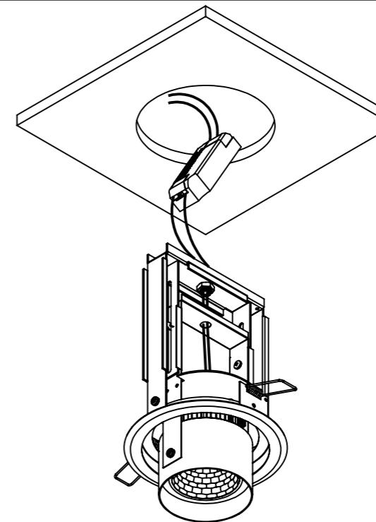
2. Conecte os cabos do driver aos cabos da rede elétrica.
