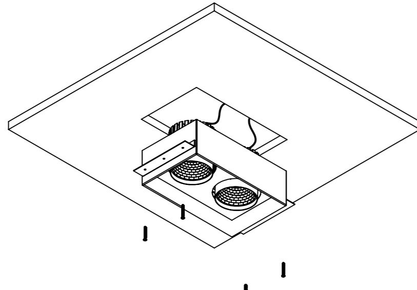
**3.Posicionar driver sobre o forro e encaixar luminaria fixando os parafusos para travamento.**
