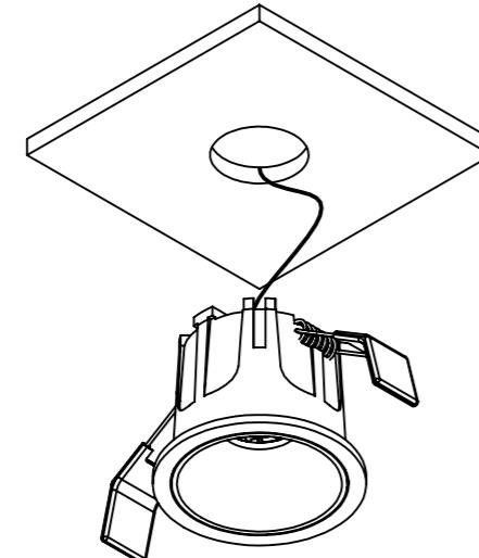
**3.Posicionar driver sobre o forro e encaixar luminaria no forro.**
