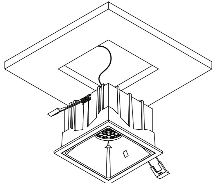
3.Posicionar driver sobre o forro e encaixar luminária no forro.
