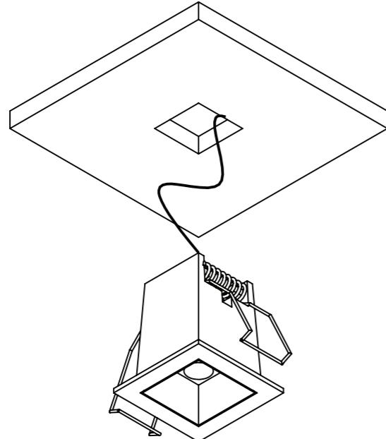
3.Posicionar driver sobre o forro e encaixar luminária no forro.
