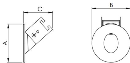
Luminária circular, 4W 3000K IRC>80. Corpo em alumínio. Acabamento Branca. Controle óptico principal através de refletor facho assimétrico. Luminária grau de proteção IP-20. Driver corrente constante Liga/Desliga Tensão de trabalho 127V ou 220V.
