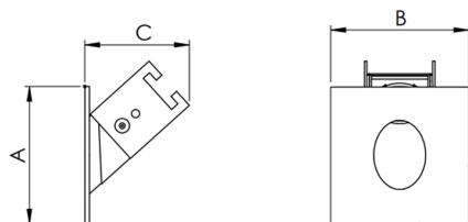
Luminária quadrada, 4W 3000K IRC>80. Corpo em alumínio. Acabamento Preta. Controle óptico principal através de refletor facho assimétrico. Luminária grau de proteção IP-20. Driver corrente constante Liga/Desliga Tensão de trabalho 127V ou 220V.
