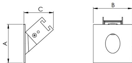
Luminária quadrada, 4W 4000K IRC>80. Corpo em alumínio. Acabamento Preta. Controle óptico principal através de refletor facho assimétrico. Luminária grau de proteção IP-20. Driver corrente constante Liga/Desliga Tensão de trabalho 127V ou 220V.
