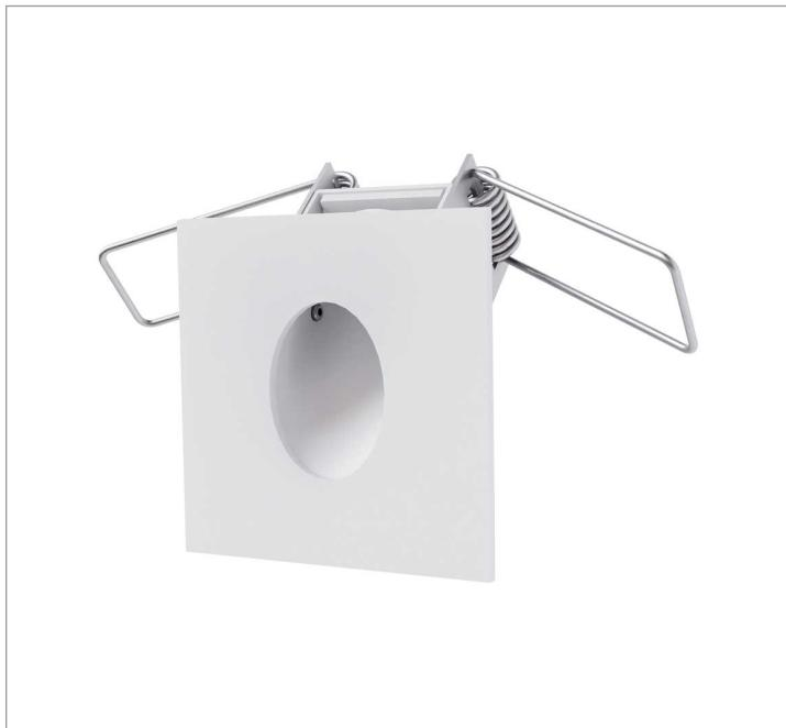
Luminária quadrada, 4W 4000K IRC>80. Corpo em alumínio. Acabamento Preto. Controle óptico principal através de refletor facho assimétrico. Luminária grau de proteção IP-20. Driver corrente constante Liga/Desliga Tensão de trabalho 127V ou 220V.
