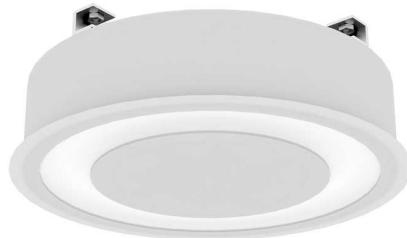
Luminária circular de embutir em forro de gesso, 100W 4000K IRC>80. Corpo em alumínio. Acabamento Branca, Preta ou Especial. Controle óptico principal através de difusor em acrílico translúcido. Luminária grau de proteção IP-20. Driver corrente constante Liga/Desliga, Triac, 1-10V ou Dali (consultar condições). Tensão de trabalho 220V ou Bivolt.
