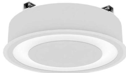
Luminária circular de embutir em forro de gesso, 20W 3000K IRC>80. Corpo em alumínio. Acabamento Branca, Preta ou Especial. Controle óptico principal através de difusor em acrílico translúcido. Luminária grau de proteção IP-20. Driver corrente constante Liga/Desliga, Triac, 1-10V ou Dali (consultar condições). Tensão de trabalho 220V ou Bivolt.
