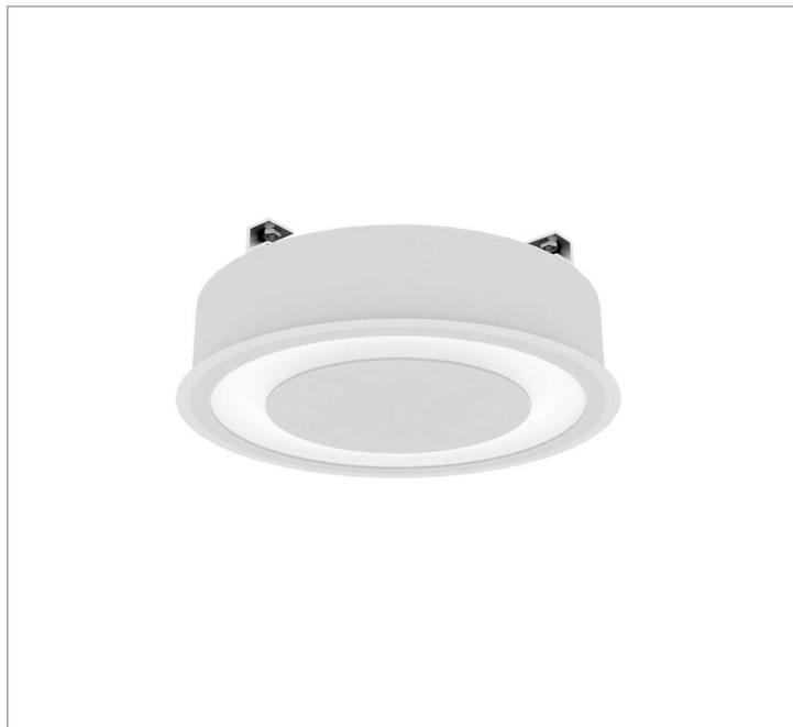
Luminária circular de embutir em forro de gesso, 20W 5000K IRC>80. Corpo em alumínio. Acabamento Branca, Preta ou Especial. Controle óptico principal através de difusor em acrílico translúcido. Luminária grau de proteção IP-20. Driver corrente constante Liga/Desliga, Triac, 1-10V ou Dali (consultar condições). Tensão de trabalho 220V ou Bivolt.
