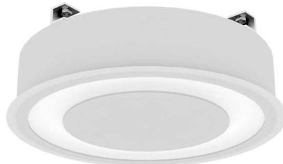
Luminária circular de embutir em forro de gesso, 40W 4000K IRC>80. Corpo em alumínio. Acabamento Branca, Preta ou Especial. Controle óptico principal através de difusor em acrílico translúcido. Luminária grau de proteção IP-20. Driver corrente constante Liga/Desliga, Triac, 1-10V ou Dali (consultar condições). Tensão de trabalho 220V ou Bivolt.
