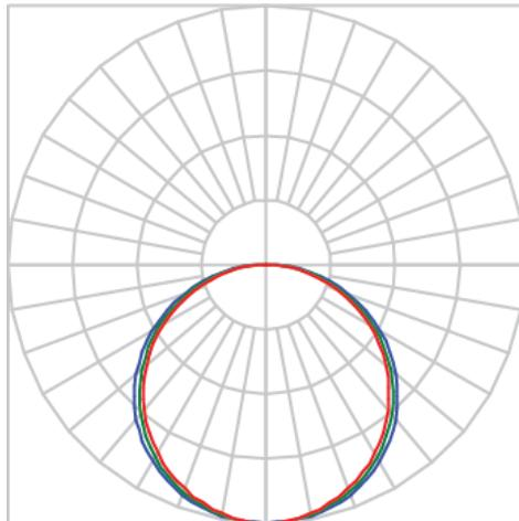
Luminária circular pendente iluminação direta, 100W 3000K IRC>80. Corpo em alumínio. Acabamento Branca, Preta ou Especial. Controle óptico principal através de difusor em acrílico translúcido. Luminária grau de proteção IP-20. Driver corrente constante Liga/Desliga, Triac, 1-10V ou Dali (consultar condições). Tensão de trabalho 220V ou Bivolt.
