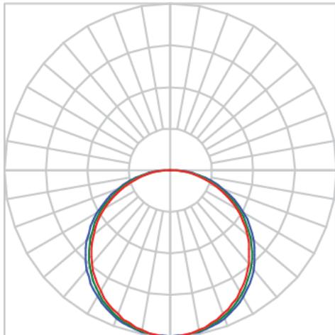
Luminária circular pendente iluminação direta, 100W 5000K IRC>80. Corpo em alumínio. Acabamento Branca, Preta ou Especial. Controle óptico principal através de difusor em acrílico translúcido. Luminária grau de proteção IP-20. Driver corrente constante Liga/Desliga, Triac, 1-10V ou Dali (consultar condições). Tensão de trabalho 220V ou Bivolt.
