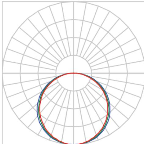
Luminária circular pendente iluminação direta, 40W 5000K IRC>80. Corpo em alumínio. Acabamento Branca, Preta ou Especial. Controle óptico principal através de difusor em acrílico translúcido. Luminária grau de proteção IP-20. Driver corrente constante Liga/Desliga, Triac, 1-10V ou Dali (consultar condições). Tensão de trabalho 220V ou Bivolt.
