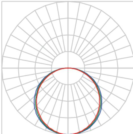
Luminária circular pendente iluminação direta, 60W 2700K IRC>80. Corpo em alumínio. Acabamento Branca, Preta ou Especial. Controle óptico principal através de difusor em acrílico translúcido. Luminária grau de proteção IP-20. Driver corrente constante Liga/Desliga, Triac, 1-10V ou Dali (consultar condições). Tensão de trabalho 220V ou Bivolt.
