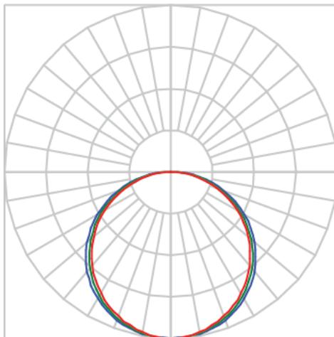
Luminária circular pendente iluminação direta, 80W 4000K IRC>80. Corpo em alumínio. Acabamento Branca, Preta ou Especial. Controle óptico principal através de difusor em acrílico translúcido. Luminária grau de proteção IP-20. Driver corrente constante Liga/Desliga, Triac, 1-10V ou Dali (consultar condições). Tensão de trabalho 220V ou Bivolt.
