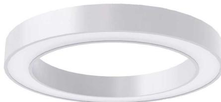
Luminária circular de sobrepor, 100W 3000K IRC>80. Corpo em alumínio. Acabamento Branca, Preta ou Especial. Controle óptico principal através de difusor em acrílico translúcido. Luminária grau de proteção IP-20. Driver corrente constante Liga/Desliga, Triac, 1-10V ou Dali (consultar condições). Tensão de trabalho 220V ou Bivolt.
