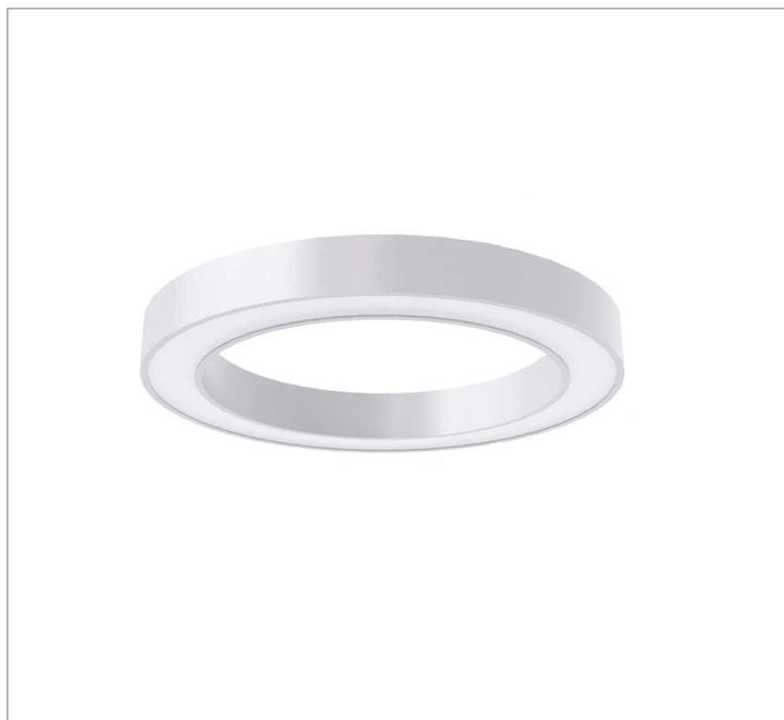
Luminária circular de sobrepor, 100W 5000K IRC>80. Corpo em alumínio. Acabamento Branca, Preta ou Especial. Controle óptico principal através de difusor em acrílico translúcido. Luminária grau de proteção IP-20. Driver corrente constante Liga/Desliga, Triac, 1-10V ou Dali (consultar condições). Tensão de trabalho 220V ou Bivolt.
