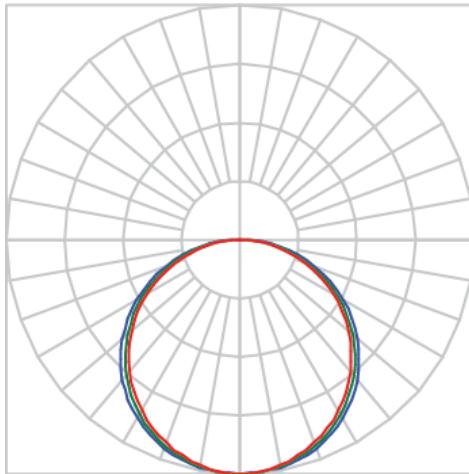
Luminária circular de sobrepor, 20W 5000K IRC>80. Corpo em alumínio. Acabamento Branca, Preta ou Especial. Controle óptico principal através de difusor em acrílico translúcido. Luminária grau de proteção IP-20. Driver corrente constante Liga/Desliga, Triac, 1-10V ou Dali (consultar condições). Tensão de trabalho 220V ou Bivolt.
