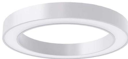
Luminária circular de sobrepor, 60W 2700K IRC>80. Corpo em alumínio. Acabamento Branca, Preta ou Especial. Controle óptico principal através de difusor em acrílico translúcido. Luminária grau de proteção IP-20. Driver corrente constante Liga/Desliga, Triac, 1-10V ou Dali (consultar condições). Tensão de trabalho 220V ou Bivolt.
