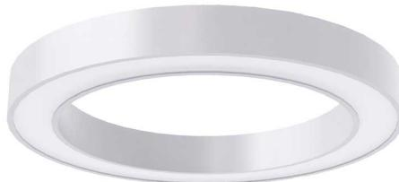
Luminária circular de sobrepor, 80W 2700K IRC>80. Corpo em alumínio. Acabamento Branca, Preta ou Especial. Controle óptico principal através de difusor em acrílico translúcido. Luminária grau de proteção IP-20. Driver corrente constante Liga/Desliga, Triac, 1-10V ou Dali (consultar condições). Tensão de trabalho 220V ou Bivolt.
