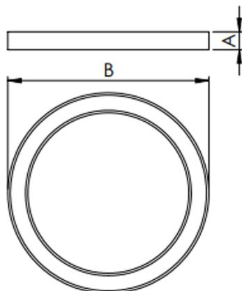
Luminária circular de sobrepor, 80W 5000K IRC>80. Corpo em alumínio. Acabamento Branca, Preta ou Especial. Controle óptico principal através de difusor em acrílico translúcido. Luminária grau de proteção IP-20. Driver corrente constante Liga/Desliga, Triac, 1-10V ou Dali (consultar condições). Tensão de trabalho 220V ou Bivolt.
