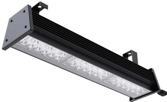
Luminária para perfilado, 200W 5000K IRC70. Corpo em alumínio. Acabamento branco, preto ou especial. Controle óptico principal através de lente facho 30°. Luminária grau de proteção IP-65. Driver corrente constante Liga/Desliga, Triac, 1-10V ou Dali (consultar condições). Tensão de trabalho 220V ou Bivolt.
