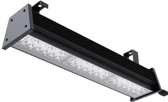
Luminária para perfilado, 100W 5000K IRC70. Corpo em alumínio. Acabamento branco, preto ou especial. Controle óptico principal através de lente facho 60°. Luminária grau de proteção IP-65. Driver corrente constante Liga/Desliga, Triac, 1-10V ou Dali (consultar condições). Tensão de trabalho 220V ou Bivolt.
