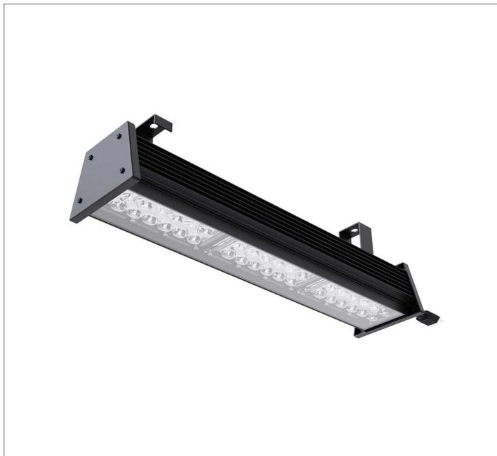
Luminária para perfilado, 150W 4000K IRC70. Corpo em alumínio. Acabamento branco, preto ou especial. Controle óptico principal através de lente facho 60°. Luminária grau de proteção IP-65. Driver corrente constante Liga/Desliga, Triac, 1-10V ou Dali (consultar condições). Tensão de trabalho 220V ou Bivolt.
