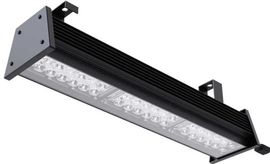
Luminária para perfilado, 100W 5000K IRC70. Corpo em alumínio. Acabamento branco, preto ou especial. Controle óptico principal através de lente facho 90°. Luminária grau de proteção IP-65. Driver corrente constante Liga/Desliga, Triac, 1-10V ou Dali (consultar condições). Tensão de trabalho 220V ou Bivolt.
