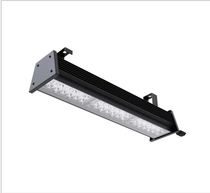
Luminária para perfilado, 100W 5000K IRC70. Corpo em alumínio. Acabamento Branca, Preta ou Especial. Controle óptico principal através de lente facho 90°. Luminária grau de proteção IP-65. Driver corrente constante Liga/Desliga, Triac, 1-10V ou Dali (consultar condições). Tensão de trabalho 220V ou Bivolt.
