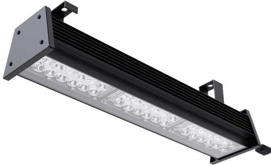
Luminária para perfilado, 50W 5000K IRC70. Corpo em alumínio. Acabamento branco, preto ou especial. Controle óptico principal através de lente facho 90°. Luminária grau de proteção IP-65. Driver corrente constante Liga/Desliga, Triac, 1-10V ou Dali (consultar condições). Tensão de trabalho 220V ou Bivolt.
