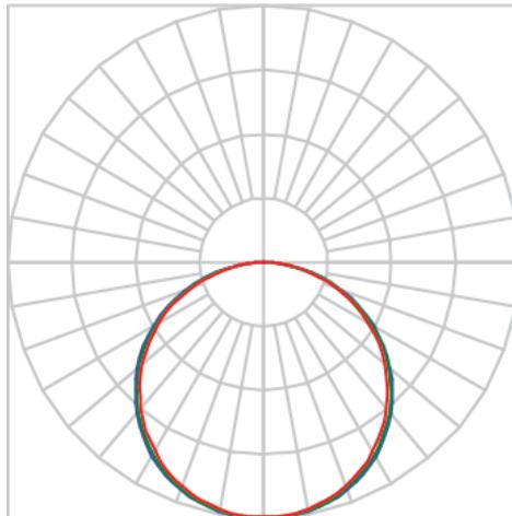
Luminária circular de embutir em forro de gesso, 100W 2700K IRC>80. Corpo em alumínio. Acabamento Branca, Preta ou Especial. Controle óptico principal através de difusor em acrílico translúcido. Luminária grau de proteção IP-20. Driver corrente constante Liga/Desliga, Triac, 1-10V ou Dali (consultar condições). Tensão de trabalho 220V ou Bivolt.
