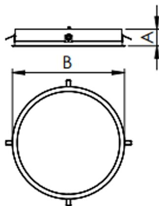
Luminária circular de embutir em forro de gesso, 40W 4000K IRC>80. Corpo em alumínio. Acabamento Branca, Preta ou Especial. Controle óptico principal através de difusor em acrílico translúcido. Luminária grau de proteção IP-20. Driver corrente constante Liga/Desliga, Triac, 1-10V ou Dali (consultar condições). Tensão de trabalho 220V ou Bivolt.
