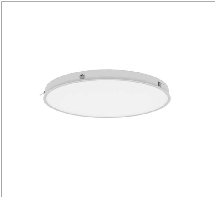
Luminária circular de embutir em forro de gesso, 40W 5000K IRC>80. Corpo em alumínio. Acabamento Branca, Preta ou Especial. Controle óptico principal através de difusor em acrílico translúcido. Luminária grau de proteção IP-20. Driver corrente constante Liga/Desliga, Triac, 1-10V ou Dali (consultar condições). Tensão de trabalho 220V ou Bivolt.
