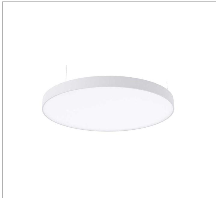
Luminária circular pendente iluminação direta, 20W 4000K IRC>80. Corpo em alumínio. Acabamento Branca, Preta ou Especial. Controle óptico principal através de difusor em acrílico translúcido. Luminária grau de proteção IP-20. Driver corrente constante Liga/Desliga, Triac, 1-10V ou Dali (consultar condições). Tensão de trabalho 220V ou Bivolt.
