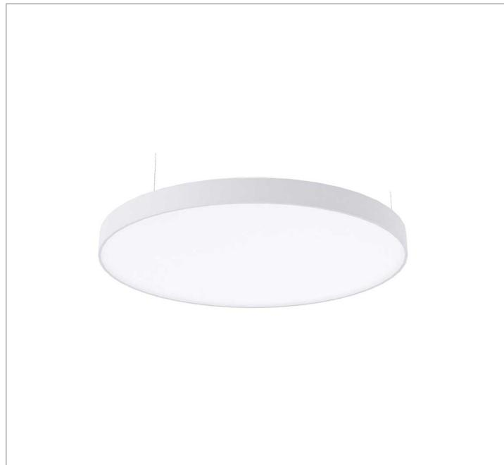
Luminária circular pendente iluminação direta, 40W 4000K IRC>80. Corpo em alumínio. Acabamento Branca, Preta ou Especial. Controle óptico principal através de difusor em acrílico translúcido. Luminária grau de proteção IP-20. Driver corrente constante Liga/Desliga, Triac, 1-10V ou Dali (consultar condições). Tensão de trabalho 220V ou Bivolt.
