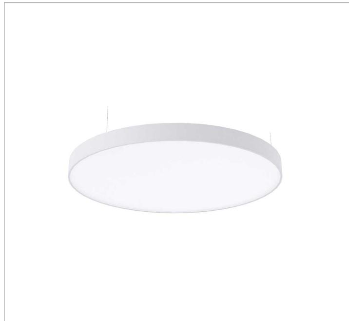
Luminária circular pendente iluminação direta, 80W 3000K IRC>80. Corpo em alumínio. Acabamento Branca, Preta ou Especial. Controle óptico principal através de difusor em acrílico translúcido. Luminária grau de proteção IP-20. Driver corrente constante Liga/Desliga, Triac, 1-10V ou Dali (consultar condições). Tensão de trabalho 220V ou Bivolt.
